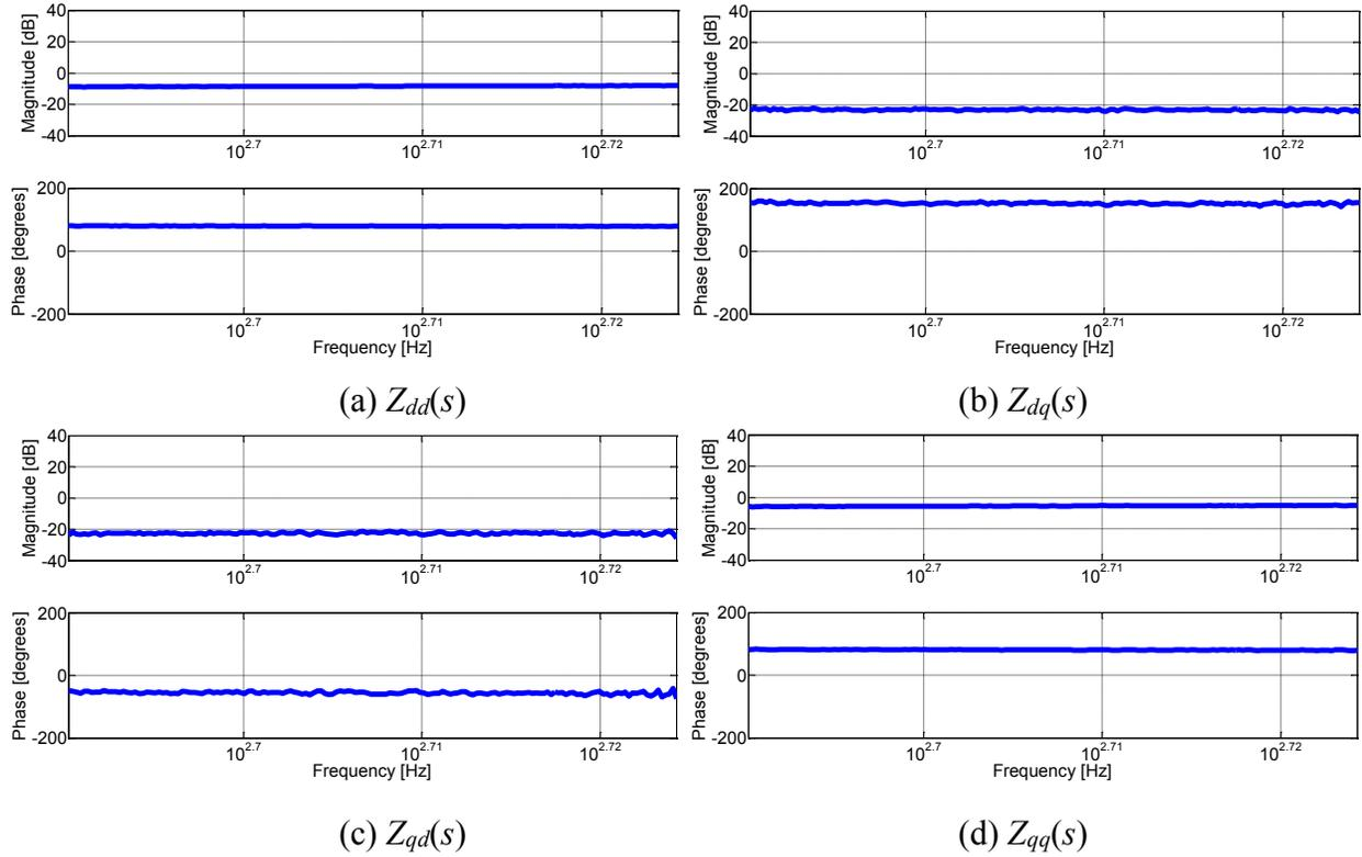
**Figure 7-8: Source small-signal dq impedances obtained via current injection of chirp signal (a)  $Z_{dd}(s)$  (b)  $Z_{dq}(s)$  (c)  $Z_{qd}(s)$  (d)  $Z_{qq}(s)$**
