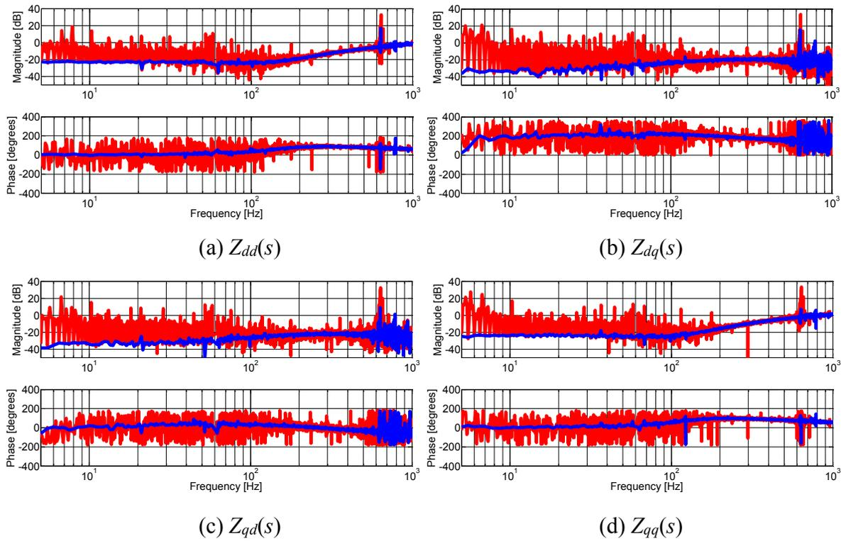
**Figure 7-4: Comparison of source dq impedances obtained via voltage injection of chirp signal (a)  $Z_{dd}(s)$  (b)  $Z_{dq}(s)$  (c)  $Z_{qd}(s)$  (d)  $Z_{qq}(s)$**
