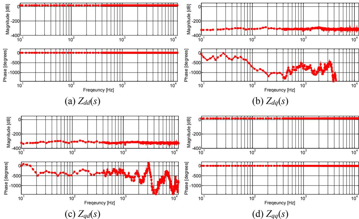
**Figure 2-17: Bode diagram of load impedances in dq coordinates (a)  $Z_{dd}(s)$  (b)  $Z_{dq}(s)$  (c)  $Z_{qd}(s)$  (d)  $Z_{qq}(s)$**
