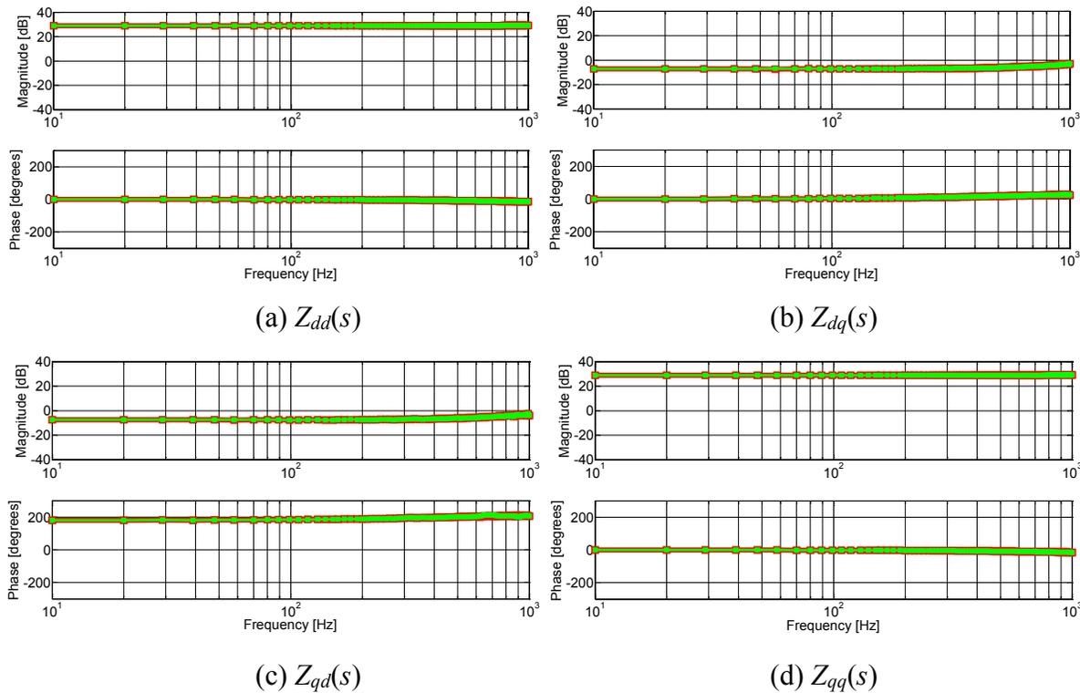
**Figure 7-5: Comparison of load dq impedances obtained via voltage injection of multi-tone signal (a)  $Z_{dd}(s)$  (b)  $Z_{dq}(s)$  (c)  $Z_{qd}(s)$  (d)  $Z_{qq}(s)$**
