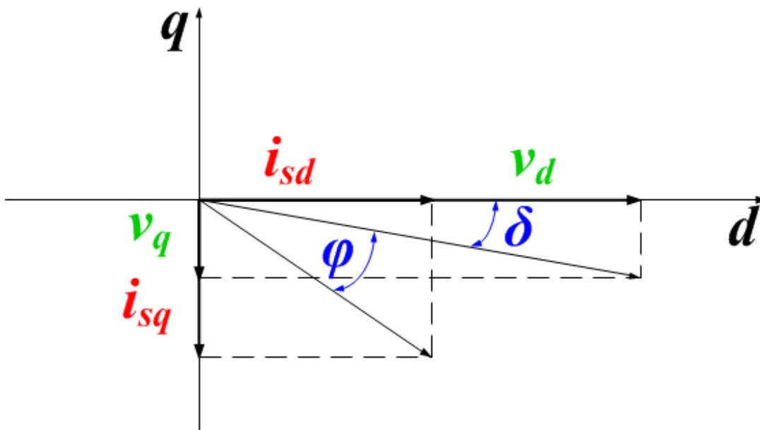
**Figure 3-6: Phasor diagram of dq currents and dq voltages used in PAVM**
