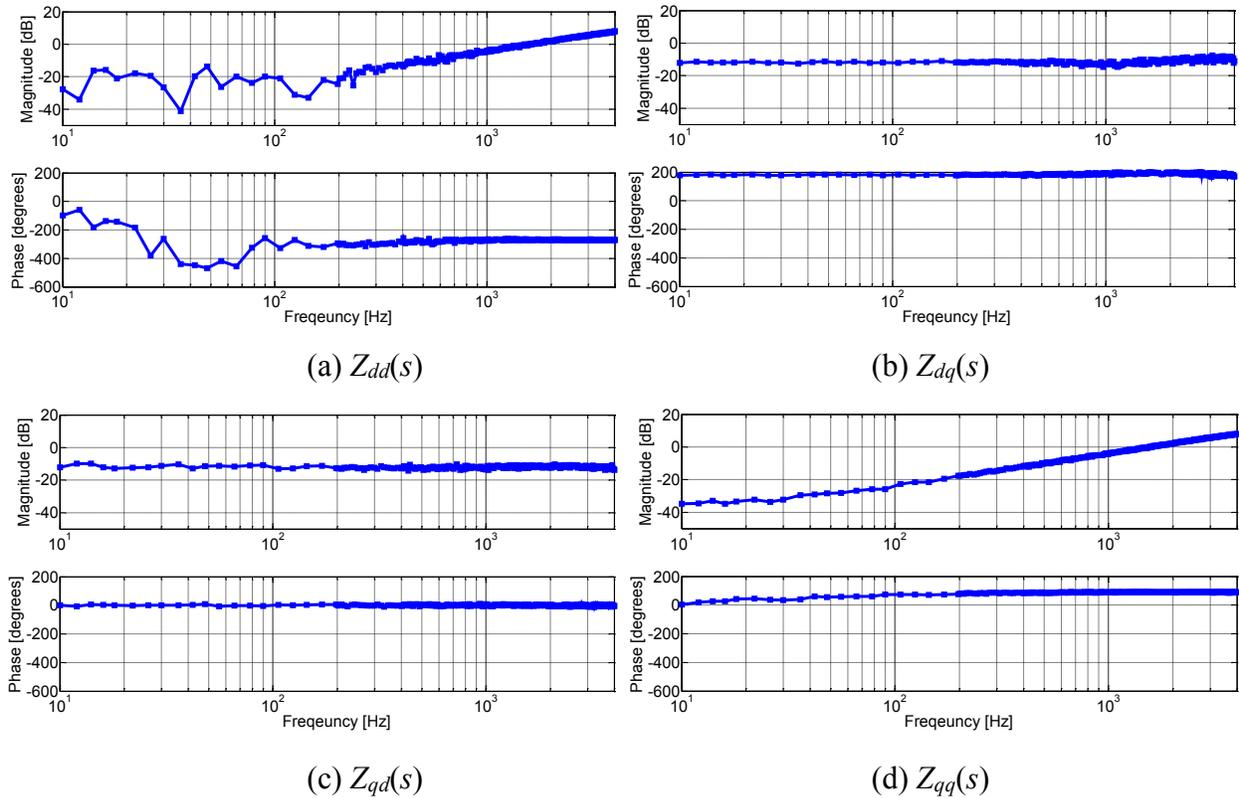
**Figure 2-21: Comparison of boost rectifier input dq impedances obtained by switching model and dq averaged model (a)  $Z_{dd}(s)$  (b)  $Z_{dq}(s)$  (c)  $Z_{qd}(s)$  (d)  $Z_{qq}(s)$**
