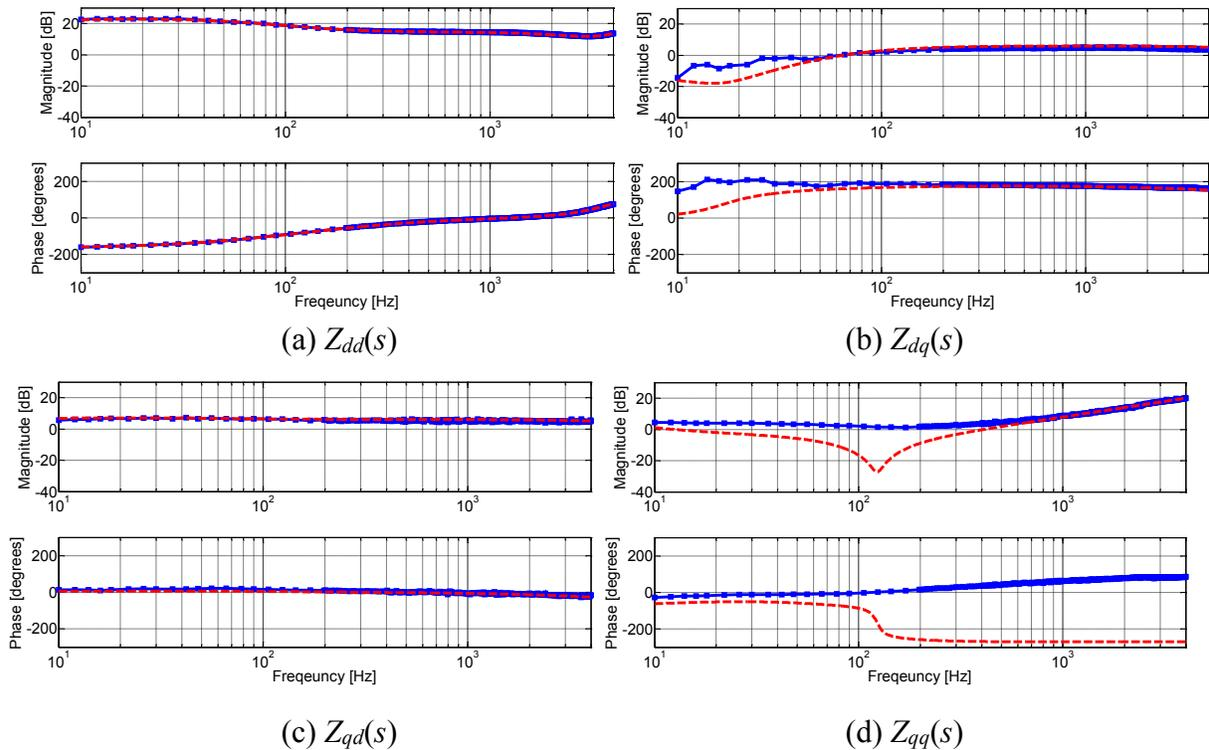
**Figure 2-20: Comparison of boost rectifier input dq impedances obtained by switching model (straight blue line) and dq averaged model (dashed red line) (a)  $Z_{dd}(s)$  (b)  $Z_{dq}(s)$  (c)  $Z_{qd}(s)$  (d)  $Z_{qq}(s)$**
