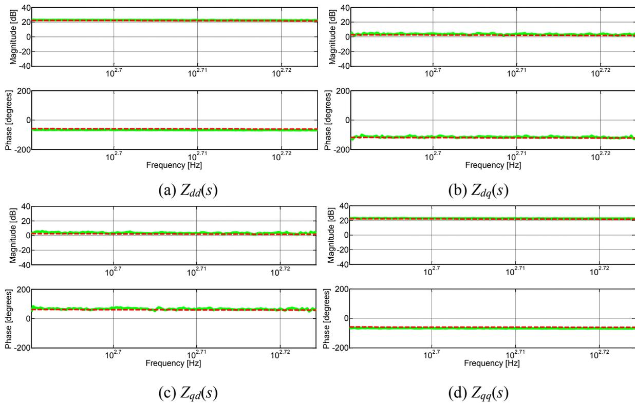
**Figure 7-7: Comparison of load dq impedances obtained via current injection of chirp signal (a)  $Z_{dd}(s)$  (b)  $Z_{dq}(s)$  (c)  $Z_{qd}(s)$  (d)  $Z_{qq}(s)$**
