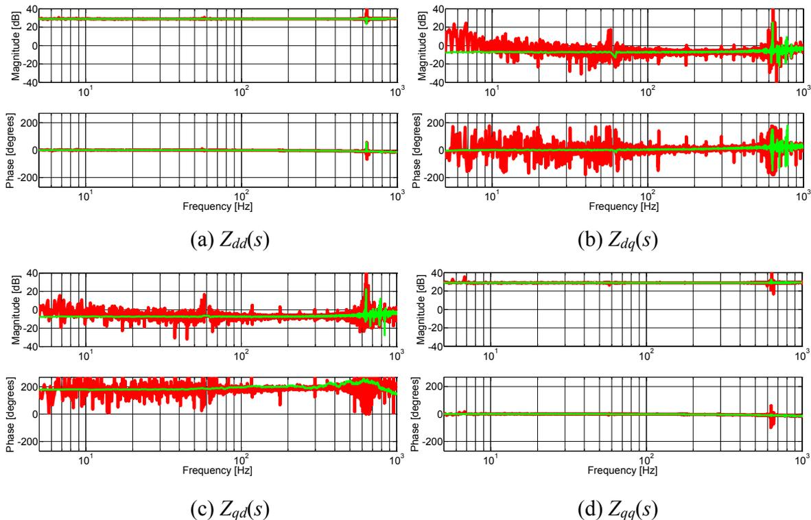
**Figure 7-3: Comparison of load dq impedances obtained via voltage injection of chirp signal (a)  $Z_{dd}(s)$  (b)  $Z_{dq}(s)$  (c)  $Z_{qd}(s)$  (d)  $Z_{qq}(s)$**
