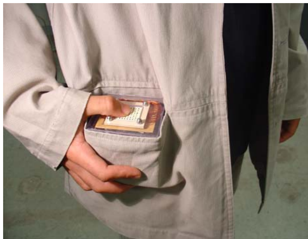
Figure D.13: Première version d'une interface tactile portable à bas coût pour les déficients visuels basée sur des micro-actionneurs en alliages à mémoire de forme (AMF).
