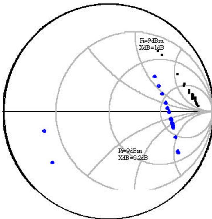
**Figure 4.8** XdB Compression Gain,  $V_{DS}=7\text{ V}$ .
