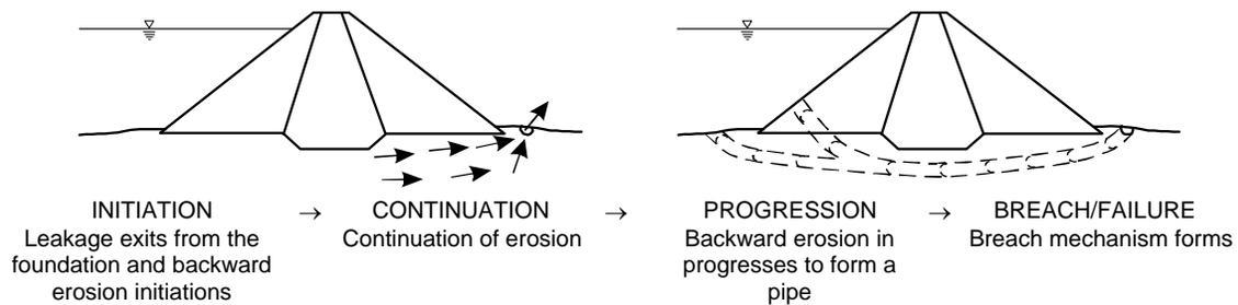
(A) PIPING IN THE FOUNDATION INITIATED BY BACKWARD EROSION
