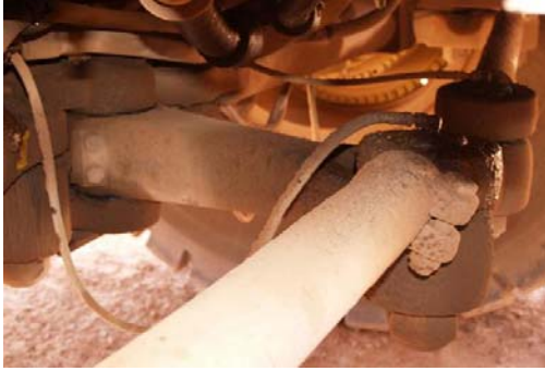
Figure 4.17 - Actual Bell Crank
