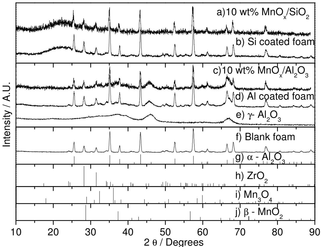
**Figure 2-3.** XRD traces: a) 10 wt %  $\text{MnO}_x/\text{SiO}_2$ , b) Si coated foam, c) 10 wt %  $\text{MnO}_x/\text{Al}_2\text{O}_3$ , d) Al coated foam, e)  $\gamma\text{-Al}_2\text{O}_3$ , f) blank foam, g)  $\alpha\text{-Al}_2\text{O}_3$  (PDF 10-173), h)  $\text{ZrO}_2$  (PDF 24-1165), i)  $\text{Mn}_3\text{O}_4$  (PDF 800382), and j)  $\beta\text{-MnO}_2$  (PDF 24-0735).
