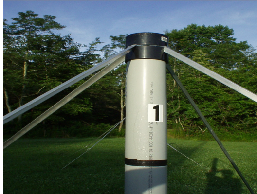
Figure 3.2: ETA antenna stand displaying two orthogonal antennas.
