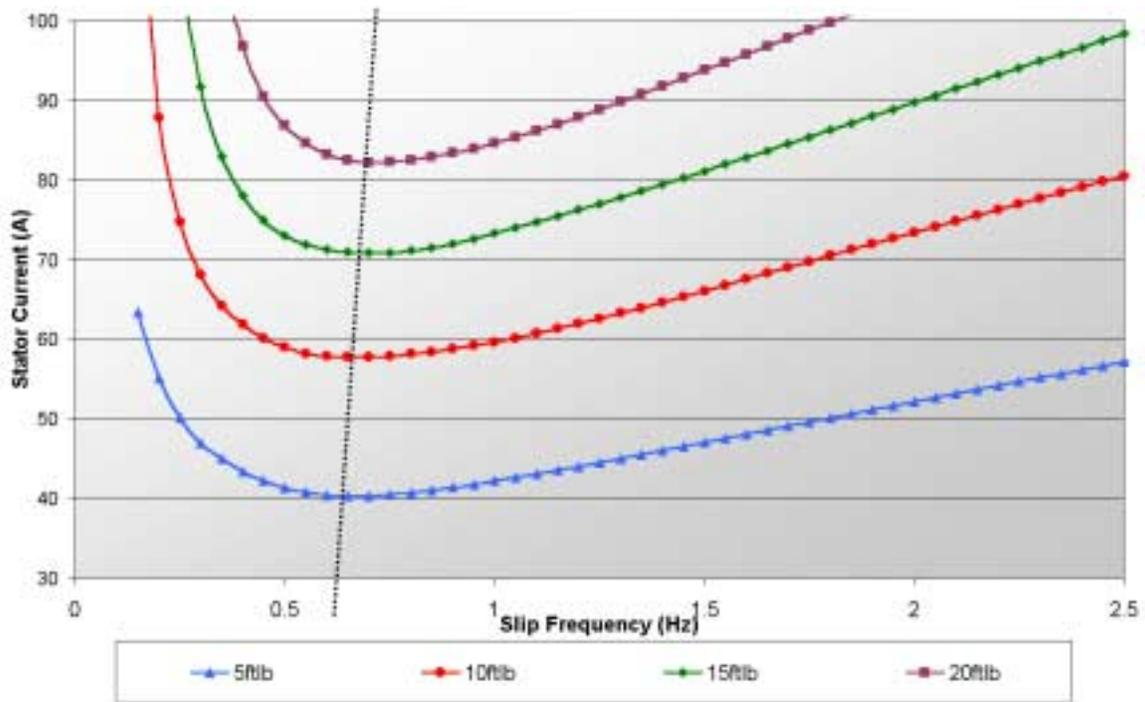
**Figure 16 Maximum Torque per Ampere - 3000RPM**
