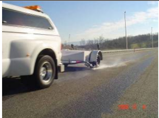
(d) Skid test
