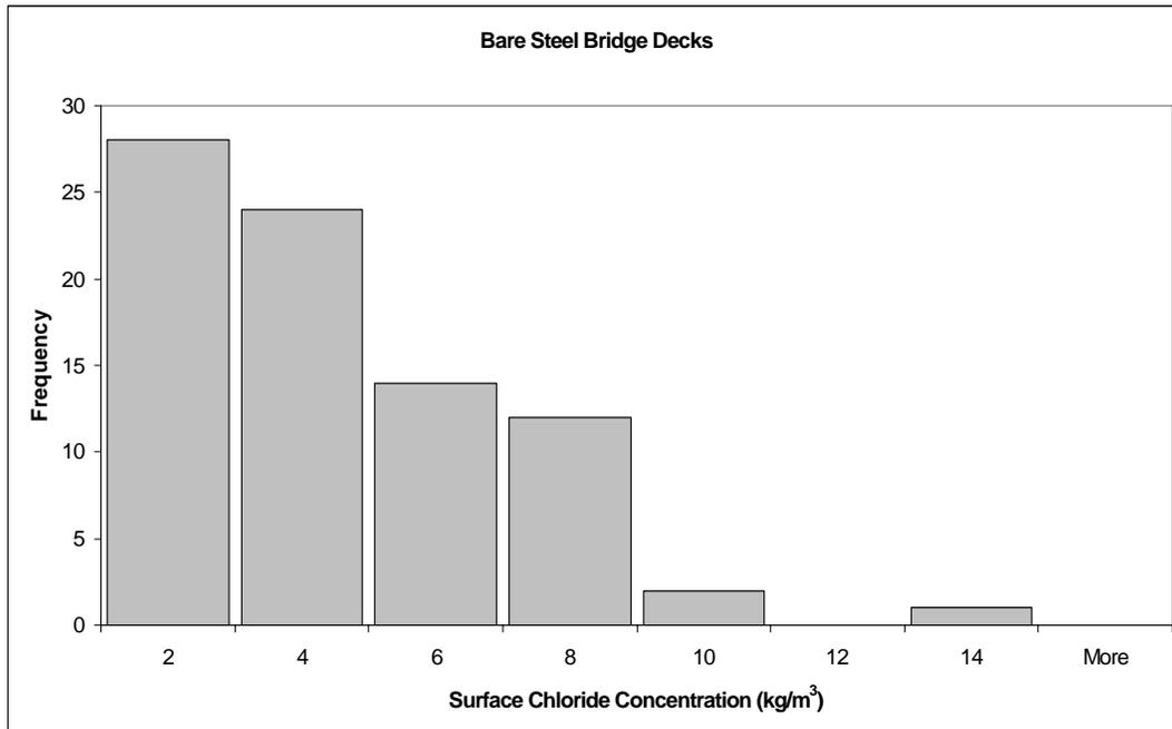
**Figure 11.  $C_o$  Measurements – 0.47 w/c**
