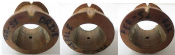
**FIGURE 13. THE LOAD (WORN) SURFACES OF FEROFROM T814 BEARINGS AFTER THE TEST. (A) DRIVE SIDE BEARING; (B) MIDDLE BEARING; (C) FAR SIDE BEARING.**
