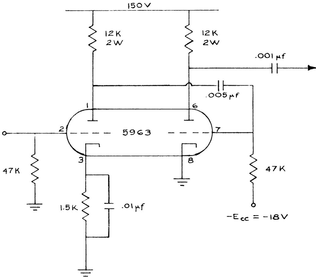
FIG. 4 PULSE AMPLIFIER FOR SCALERS
