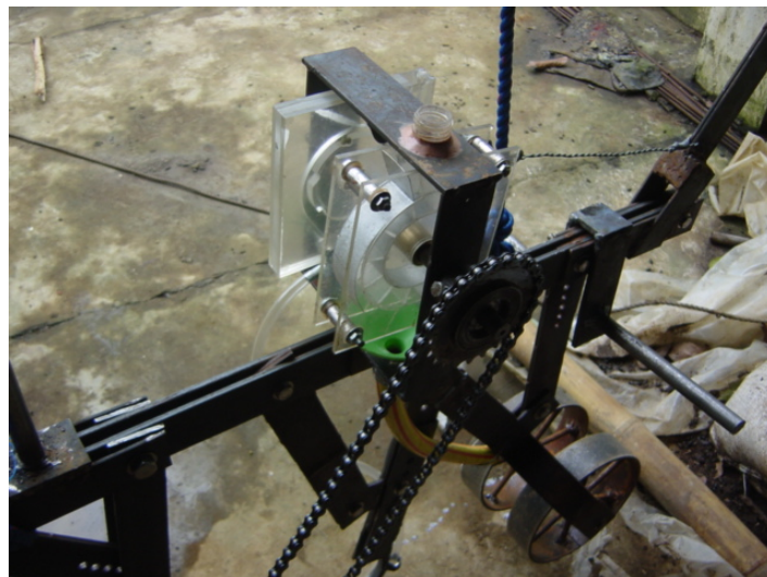
(d) Seeder & Fertilizer Dispenser Mounting
