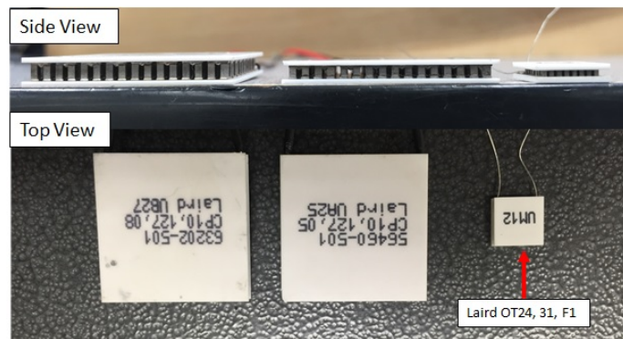
Figure 4.1: Three TEG modules: Laird CP10,08 , Laird CP10,05 and mini TEG module.
