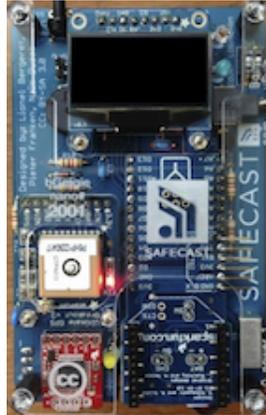
Figure 3.4: Safecast bGeigie Nano Module
