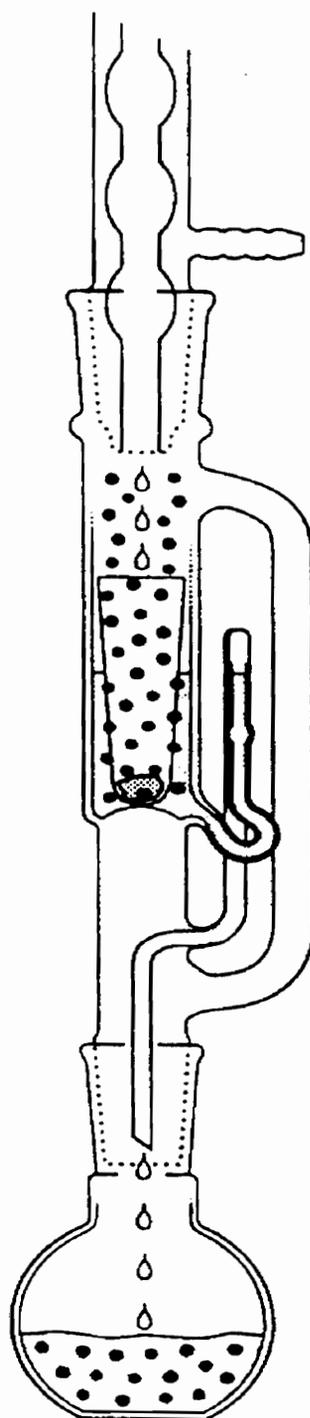
**FIGURE 13:** Soxhlet Apparatus<sup>(9)</sup>
