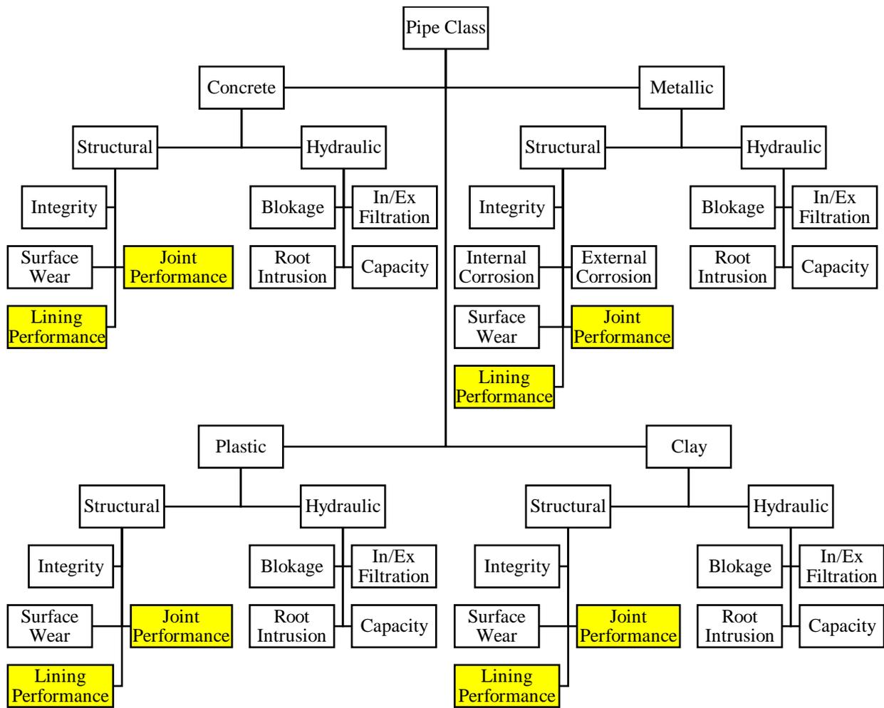
**Figure 5-7. Deterioration Modules.**
