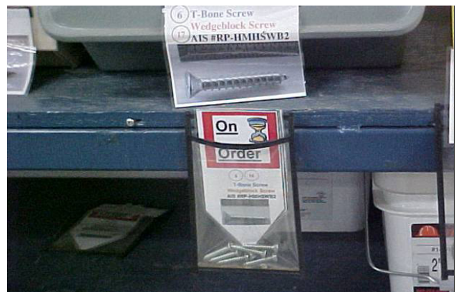
Figura 7. Tarjeta kanban utilizada en una fábrica de mobiliario institucional. La tarjeta le indica al proceso anterior que este requiere reponer inventario.
